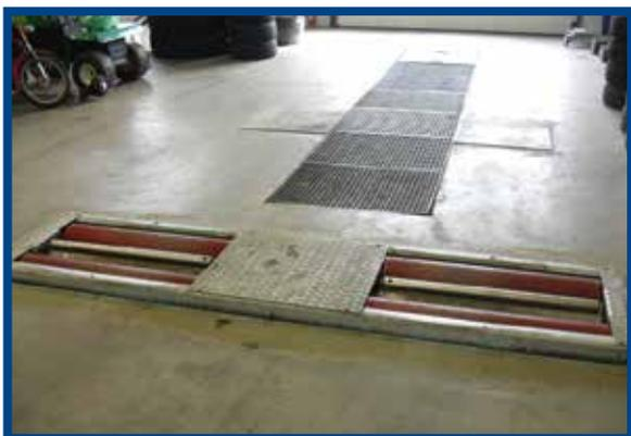
Eine neue Prüfstraße mit aushubbarem Bremsenprüfstand für erleichtertes Prüfen von Anhängern bis 3,5 t und einen Achsspieldetektor für das Prüfen von Klein LKW bis 3,5 t.
